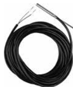
Merülő érzékelő TF/1.1P/2.5/6T, 2,5 m, FW TopTronic® E távhő-/frissvíz alapmodulhoz, illetve távhő kommunikációs alapmodulhoz - Érzékelő távhőhöz (PT1000) - vezeték hossza: 2,5 m, dugalj nélkül (a dugalj a szabályozómodul/modulbővítő a szállítási terjedelembe tartozik) - Érzékelő hüvely átnérője: 6 x 50 mm - Hármapont rögzítés - Érzékelő, esetleg a hőtermelő/szabályozómodul/modulbővítő szállítási terjedelem már tartalmazza - Alkalmazási hőmérséklet: -50 ... 105 °C - védelmi osztály: IP67
