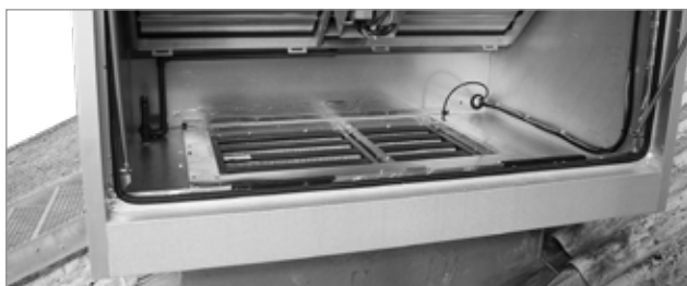
Kép: Az elszívottlevegő-szűrő elhelyezése a készülékben
