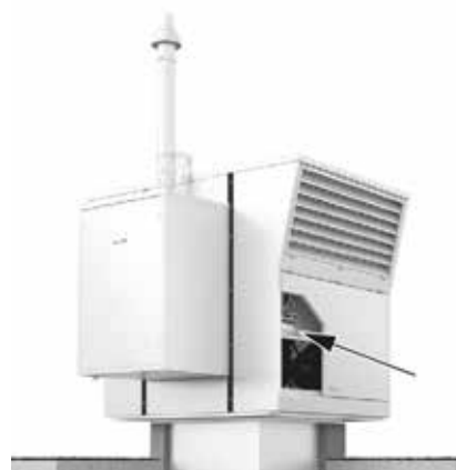
Kép: A revíziókapcsoló helyzete a befűvott-levegő revízióajtaja mögött
